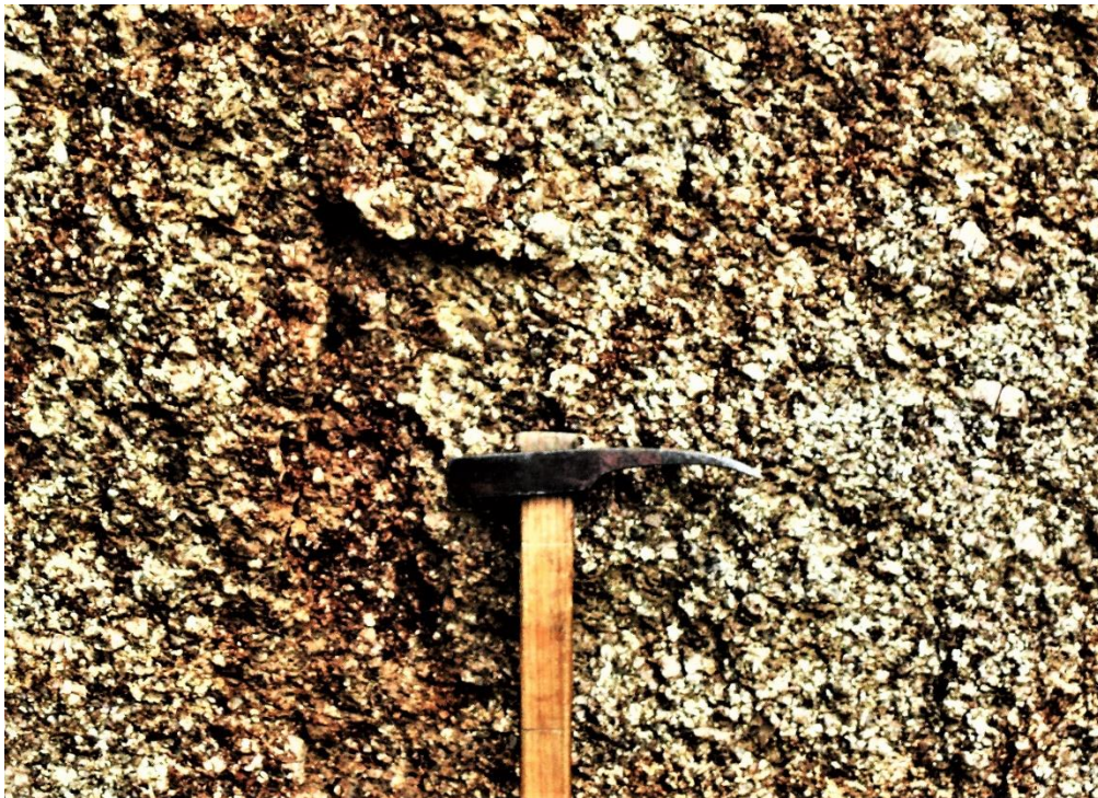
Silně rozložená středně zrnitá žula v okolí puklin stěna 290°/80°.
