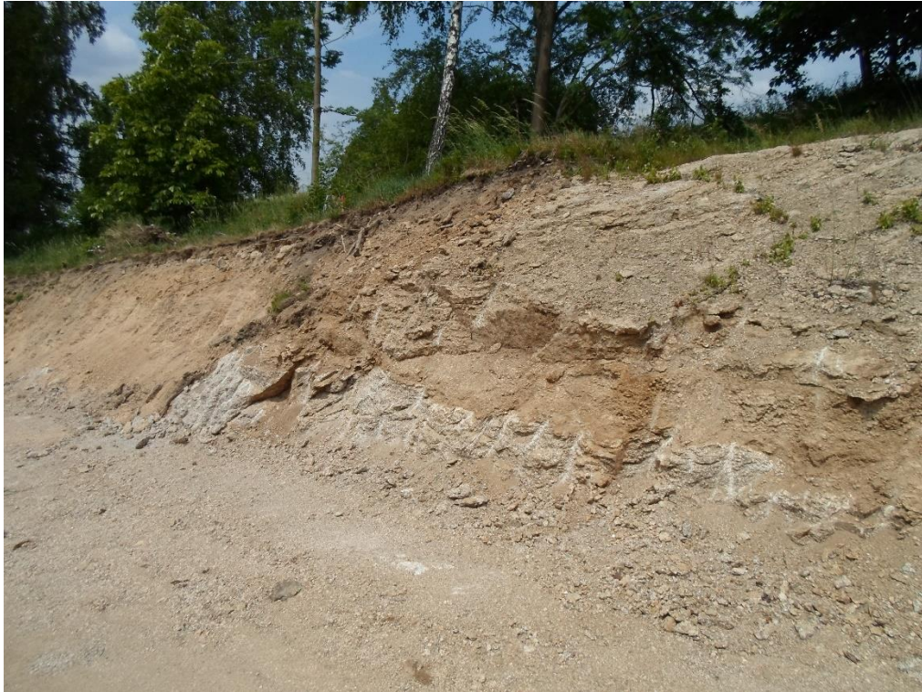
Příčné rozpukání s poměrně mírným sklonem k SV (okolo 50°)
