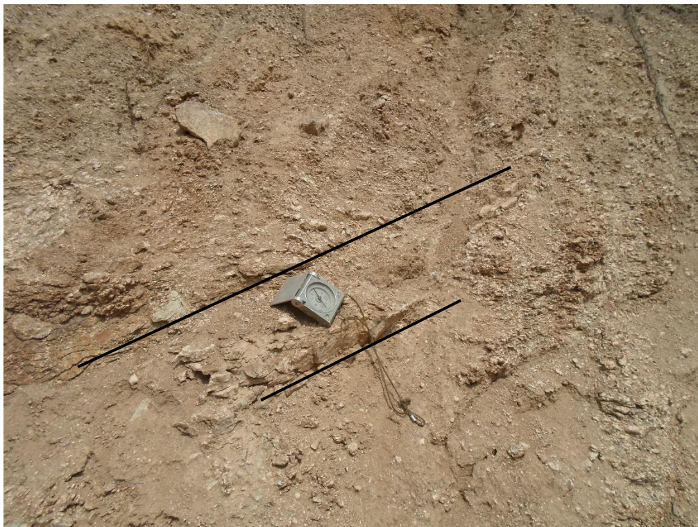
Pukliny ve zvětralé žule, sklon ploch ve směru 300°/75°;
