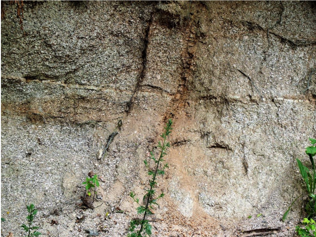
Detail puklin: Vodorovná 30°/10-15°; vyplněná žilou světlého aplitu 3 cm mocnou, prořatá dvěma puklinami 310°/75°, vyplněných křemenem až 6 cm mocné. Pukliny jsou mladší posunují vodorovnou žílu až o 10 cm.
