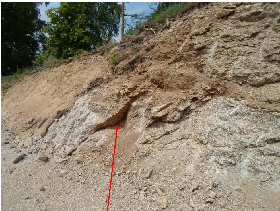
III. etáž mezi 5 a 6 domkem od Liberce zářez do svahu přes uličku Pukliny 270°/40°;
