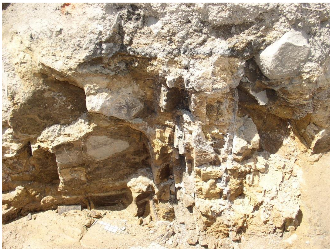
Stopy tektonického rozpukání podložní žuly 140°/85°.
