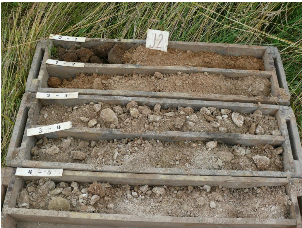
J – 1, Rýnovice – hala - bělošedé polohy pevná žula - vrtáním na sucho na povrchu spálená hornina
