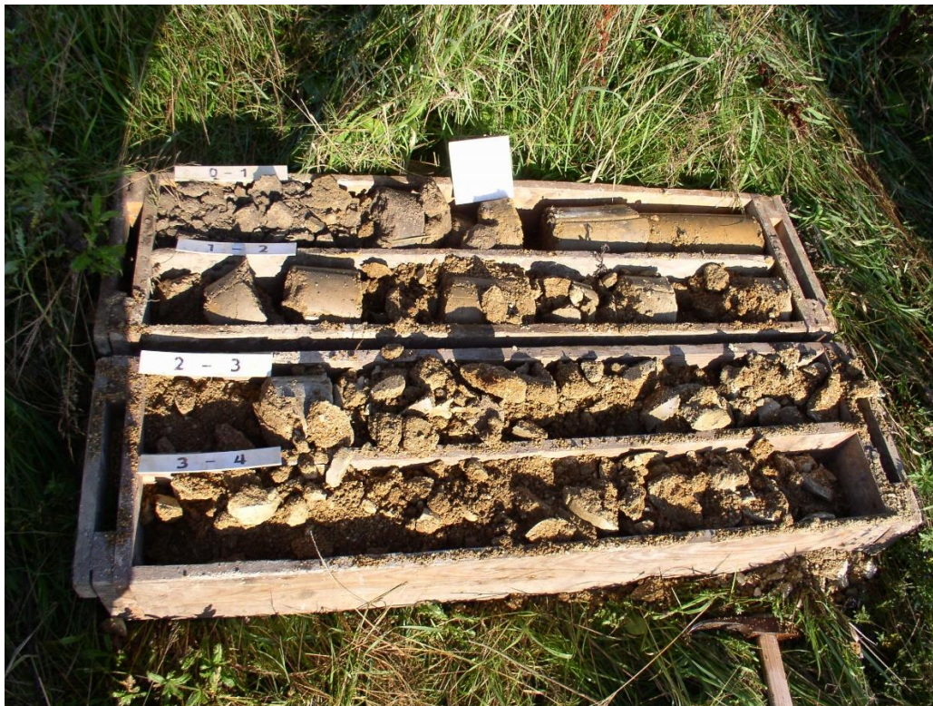
J – 1, Rýnovice – hala - bělošedé polohy pevná žula - vrtáním na sucho na povrchu spálená hornina
