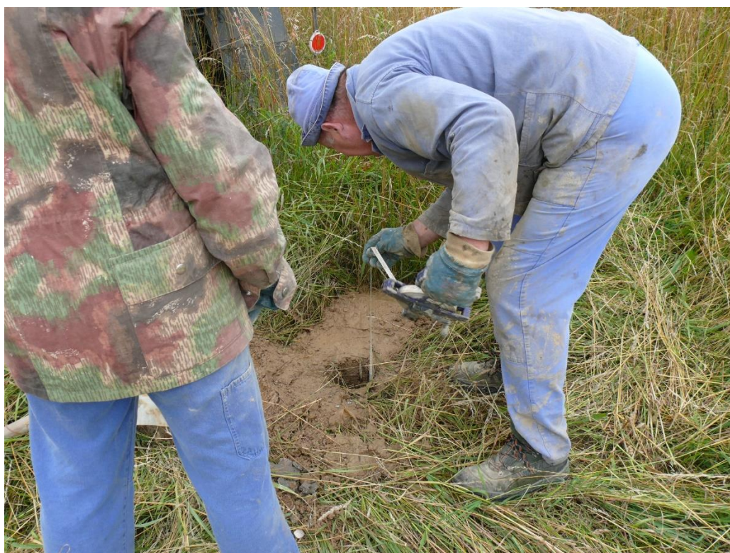
Měření hladiny vody ve vrtu J – 3
