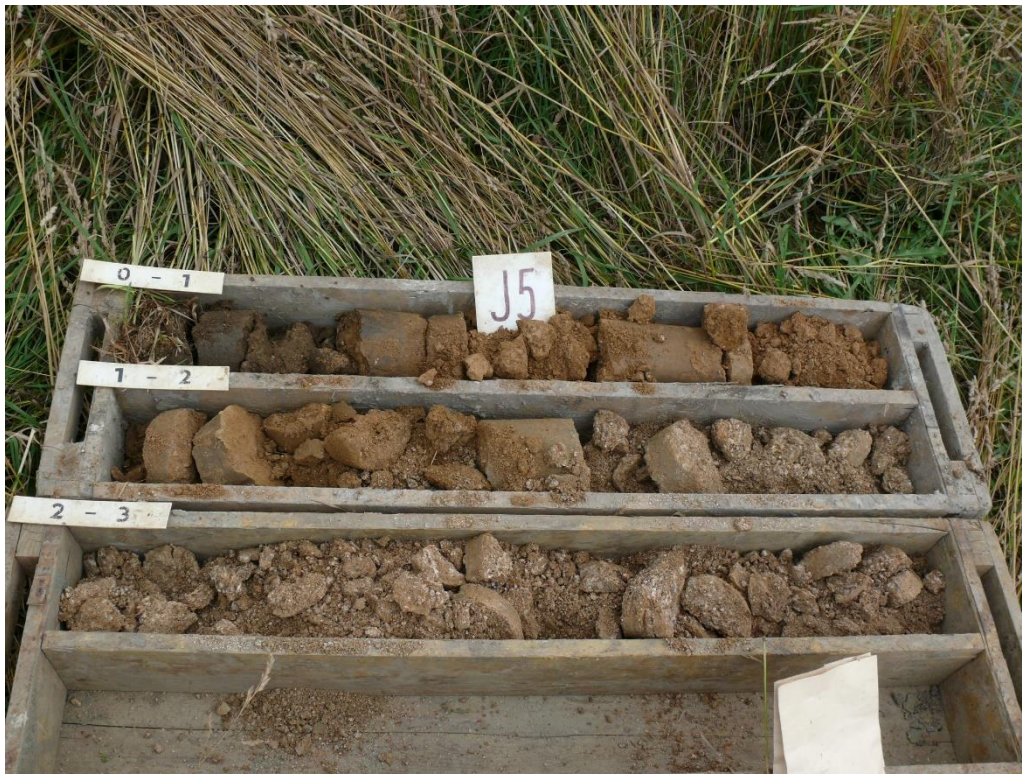
Fotodokumentace vrtu J - 5
