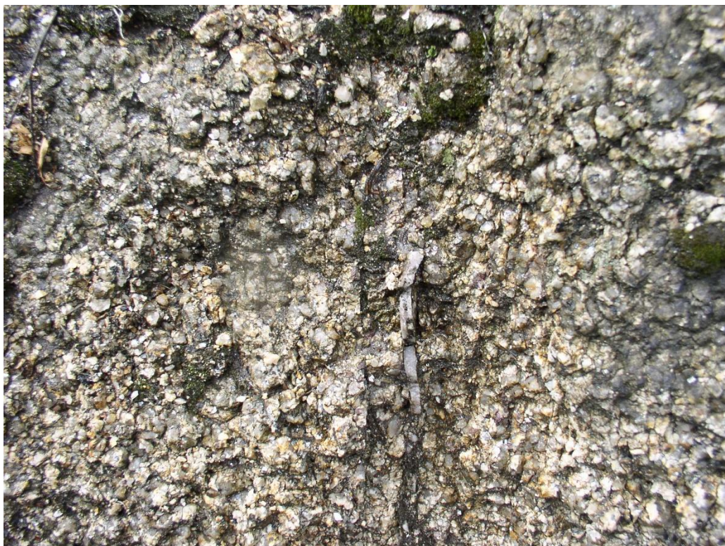
5 m dále podrcené pásmo s limonitizací na puklinách a s tenkou žilkou \text{SiO}_2 , 1/2 cm mocnou 75°/90 až 83°/80°,
