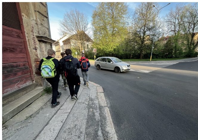
Ukázka nedostatečného nároží a absence přecházení v křižovatce (SNP x 5. května)
