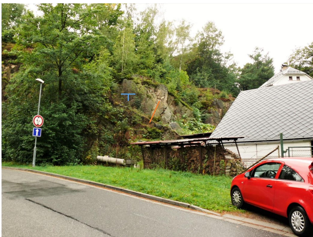
Příčné pukliny (červené) 330^{\circ}/70^{\circ} ; Pukliny podélné(modrě) mají plochy 220^{\circ}/80^{\circ} ; oba směry jsou na výchoze výrazně zastoupeny
