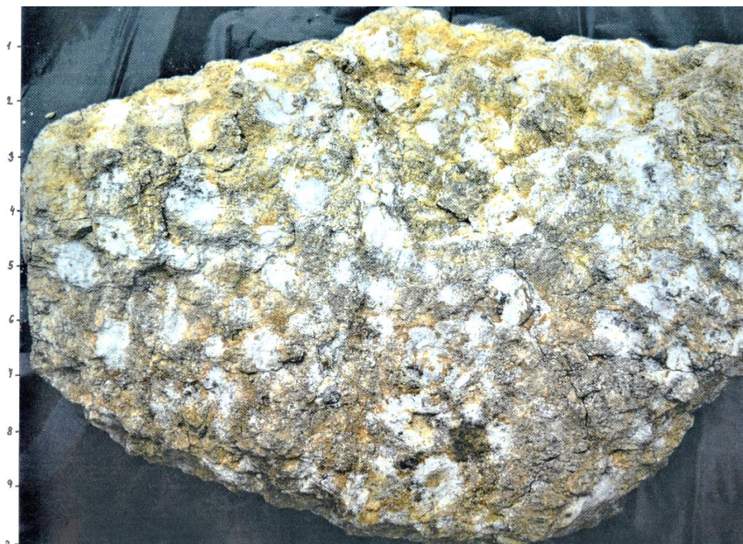
Vzorek okaté ortoruly ze dna studny. Pohled na plochu odlučnosti.
