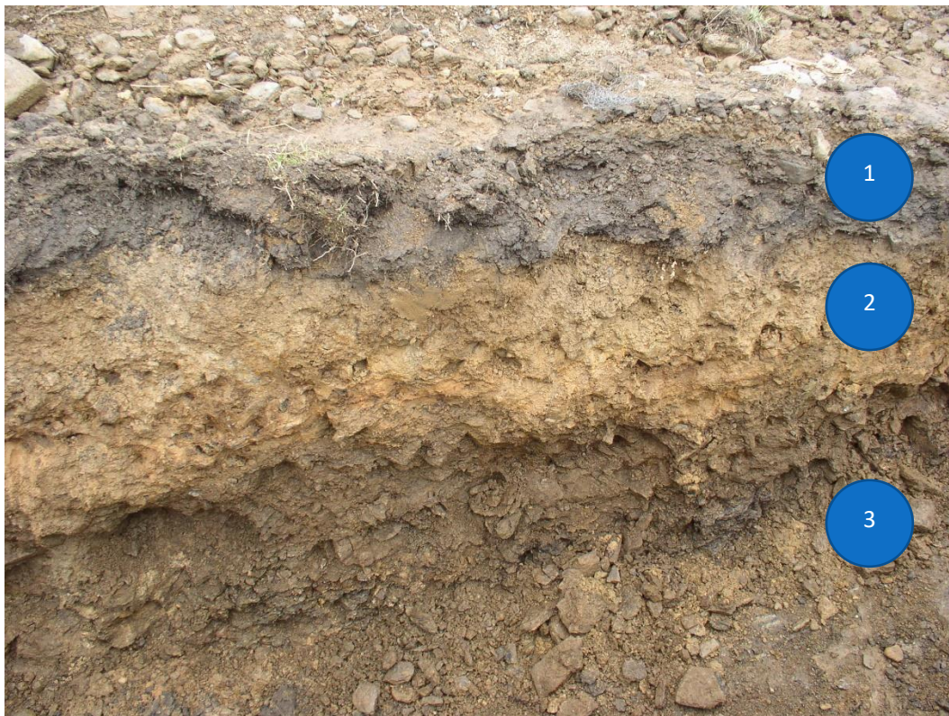
1. půdní horizont 2. deluvium žuly 3 deluvium svoru
