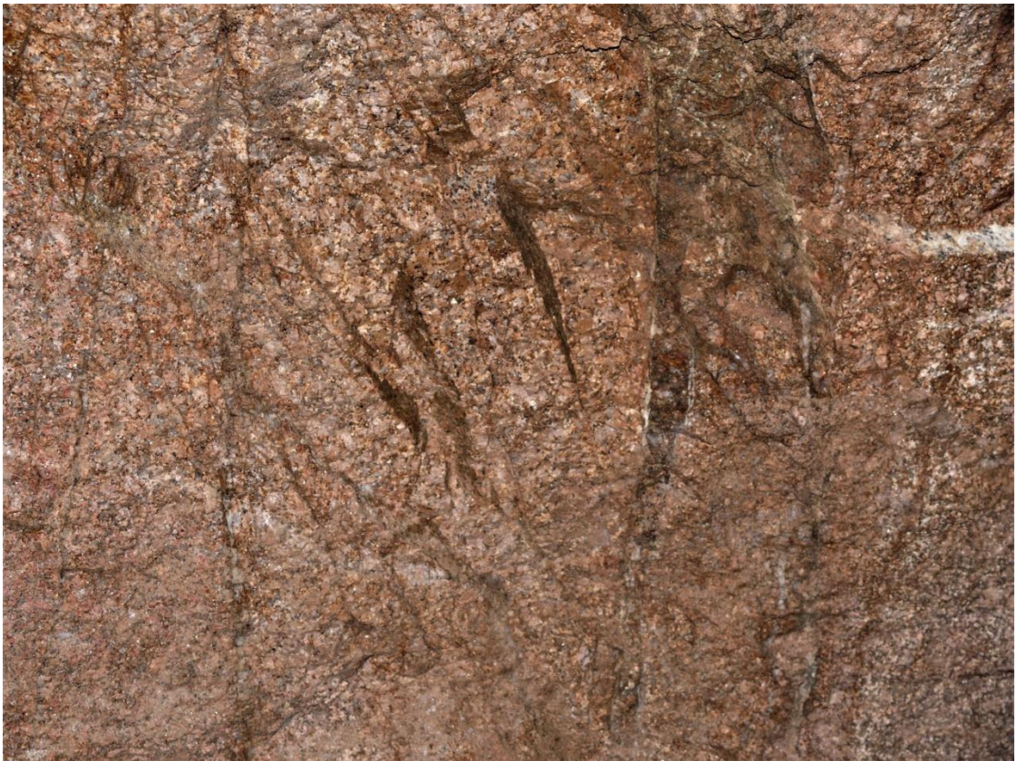
Pukliny často vyplněné drobnými žilami křemene Puklinová měření: 30°/80°; 30°/80°; 290°/70°; 70°/80°; 100°/45°; 110°/70°; 70°/85°; 80°/80°; 50°/80°; 290°/70°; 300°/80°;
