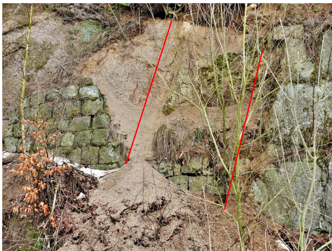
Detail stěny lomu, výrazně podrcené pásmo mezi pevnějšími bloky. Sklon a směr sklonu v obou liniích 70° až 75°/80°.
