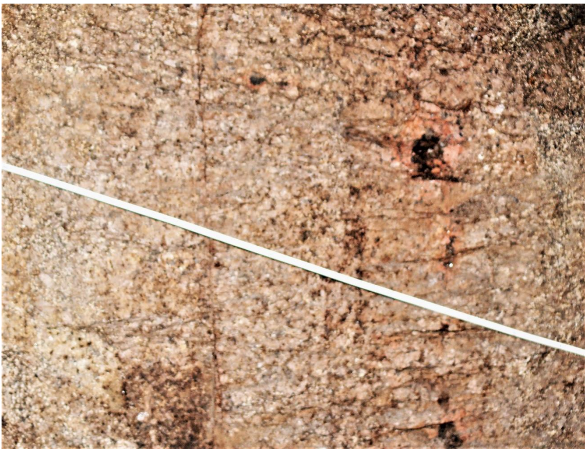
25 cm mocná svislá žíla aplitu s drobnými čočkami pegmatitu, aplit je deskovitě rozpukaný, plochy upadají ve směru 120°/25°, žíla aplitu má sklon 40°/80°;
