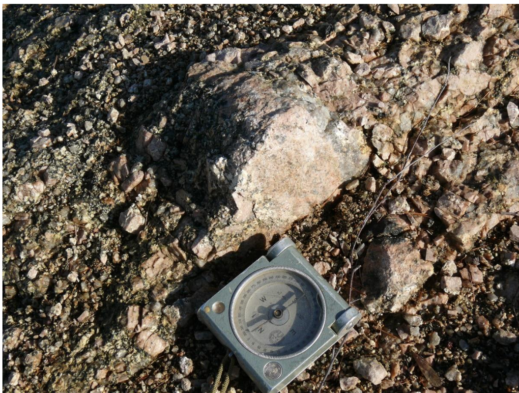
Puklinou prořatá pegmatitová čočka malých rozměrů cca 40 x 60 cm – sklon pukliny 180°/75°
