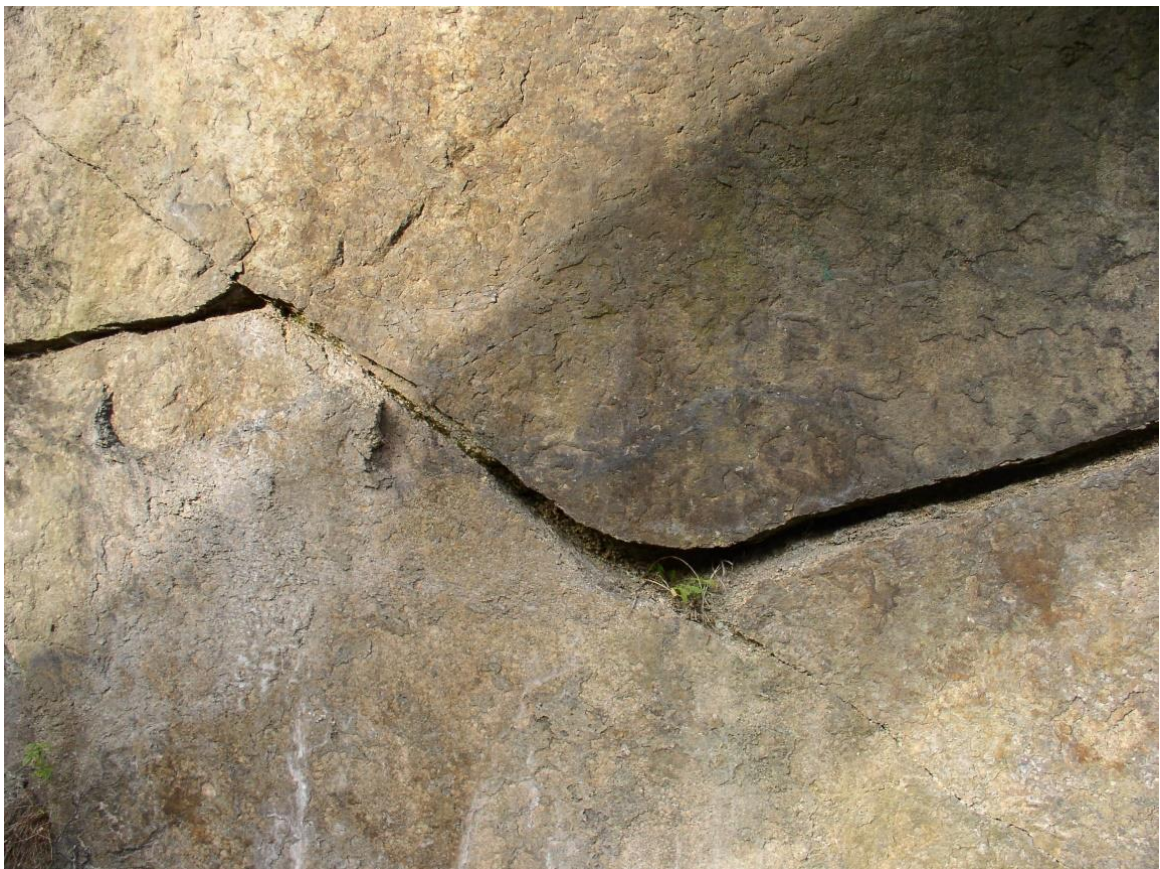
Otevírající se pukliny s mírnými sklony - patrně způsobeno pnutím v hornině vlivem tektonických pohybů celého území.
