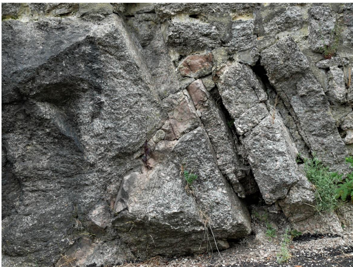
Pukliny: 105^{\circ}/70^{\circ} 5 cm široká s výplní žulové drti; 125^{\circ}/75^{\circ} (4x); 210^{\circ}/85^{\circ}
