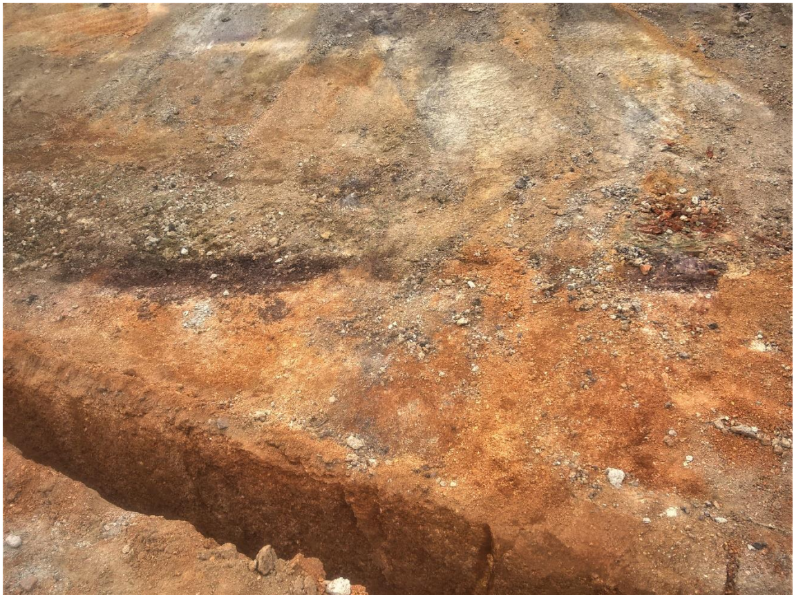
Pravý bok hřiště zachycuje okraj uvedené tektonické zóny, silně limonitizovaná drť žuly, okraj mylonitizované, tektonické zóny.
